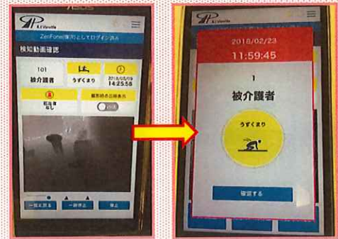
▲赤外線センサーで感知した実際のシルエット画像異常を検知した場合は職員が保有する端末に即時放置を行います。
